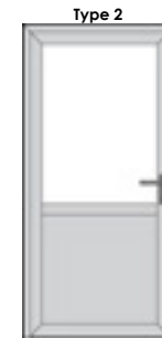
Type 2 Standaard loopdeur met 1 onderbreking met enkel veiligheidsglas en stalen vulling
